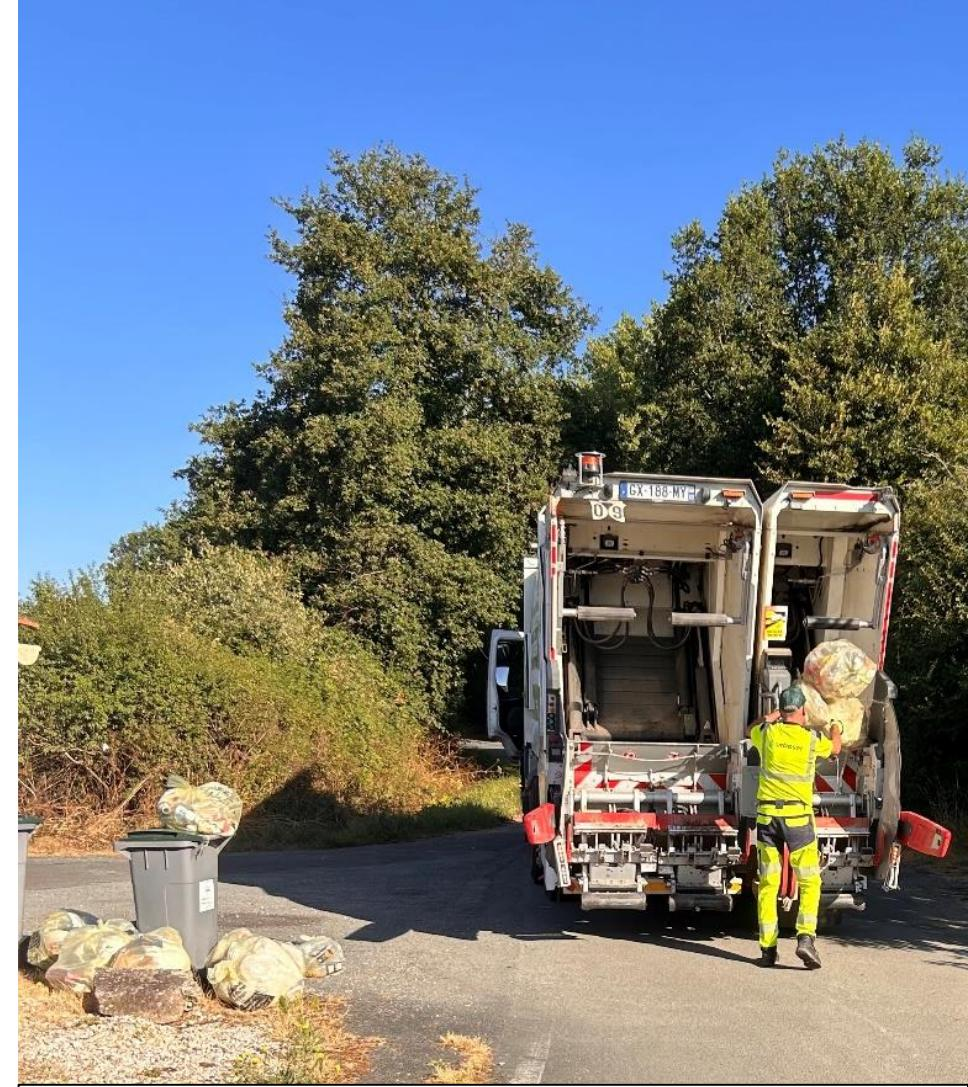
*Benne bi-compartimentée de 26 tonnes pour la collecte des ordures ménagères et des emballages en simultanée*
