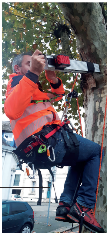
Réalisation d'un diagnostic approfondi à l'aide d'un résistographe
