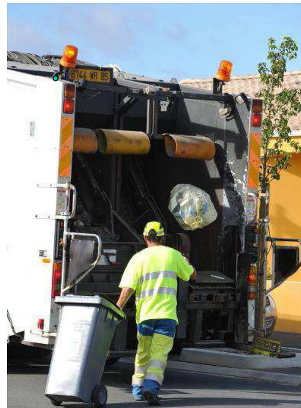
*Benne bi-compartmentée de 26 tonnes pour la collecte des ordures ménagères et des emballages en simultanée*
