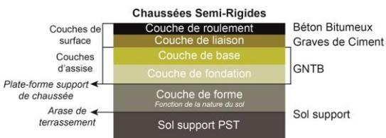
Protéger l'assise avec une couverture bitumineuse d'épaisseur suffisante (>5 cm)
